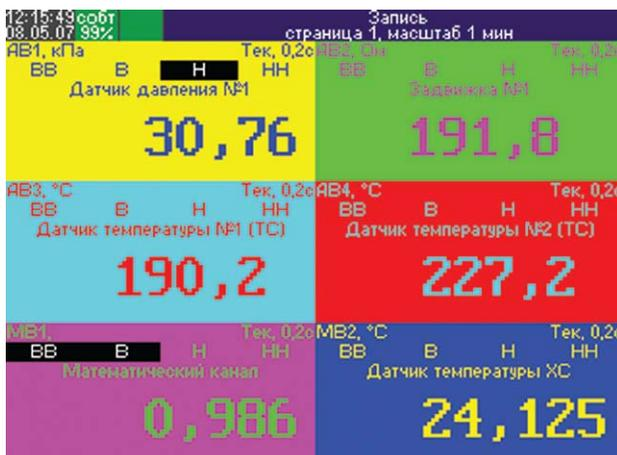
**3. Цифровое отображение.** Отображаются: текущее значение сигнала для каждого канала, имя канала, единица измерения, тип и период выборки.
