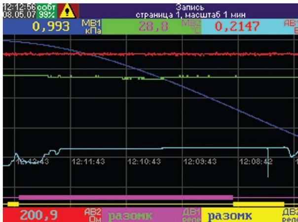
**1. Тренды.** Предусмотрена вертикальная и горизонтальная ориентация трендов, а так же отображение на темном и светлом фоне. Масштаб временной оси задается при настройке. Для исполнения 3 возможно раздельное отображение трендов.
