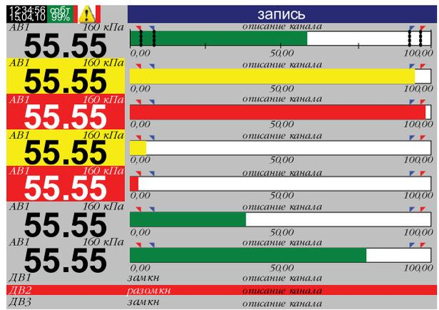
6. Одноцветные шкалы. При срабатывании предуставки значение выделяется желтым цветом. При срабатывании уставки – красным.
