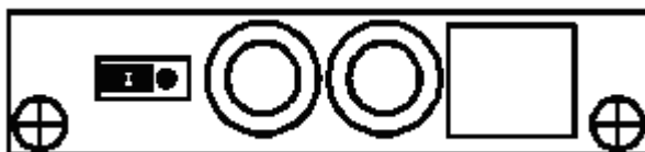
Рисунок 8-Положение переключки для режима “HART модем”
